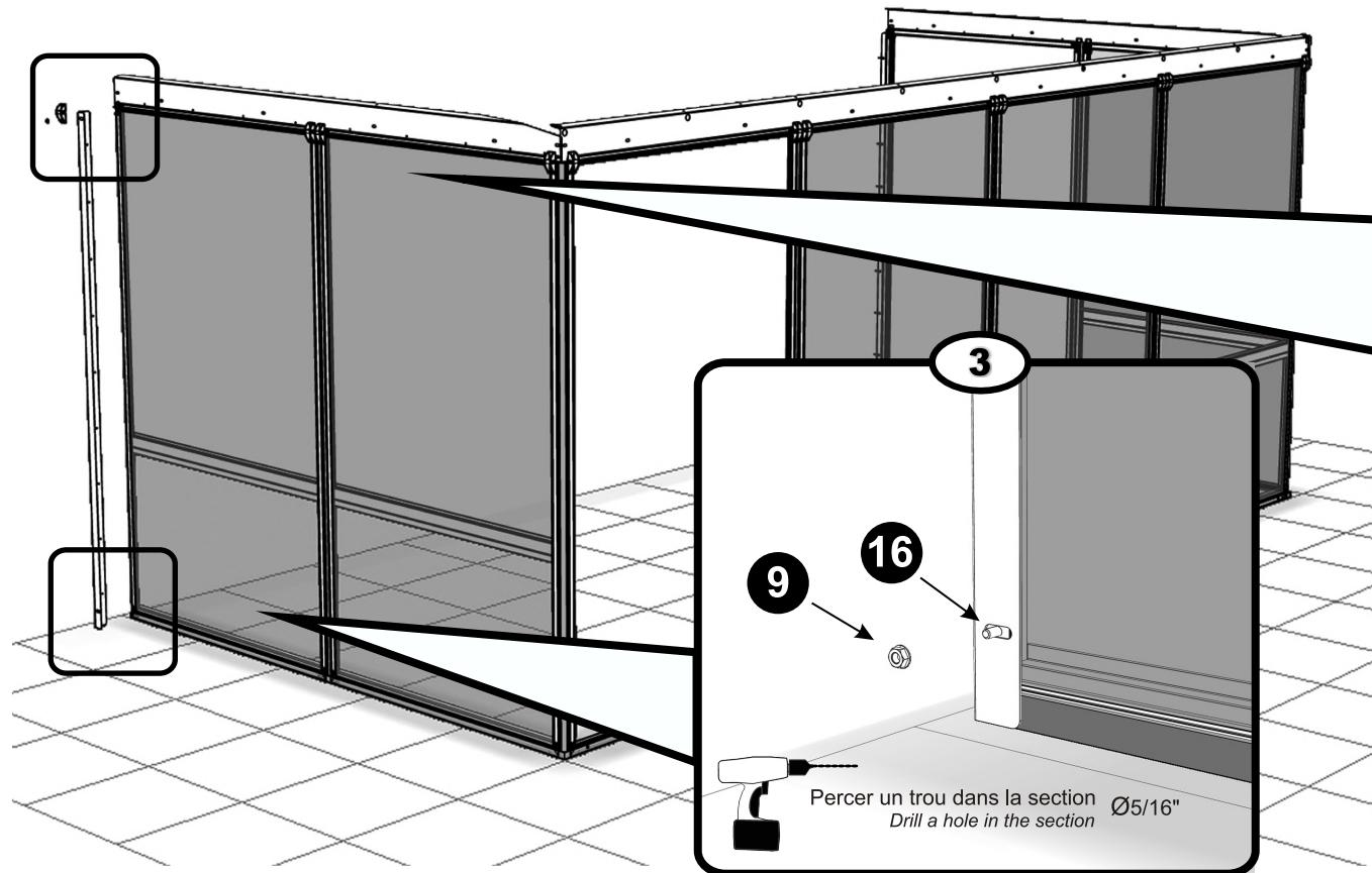
Percer un trou dans la section  $\varnothing 5/16"$
