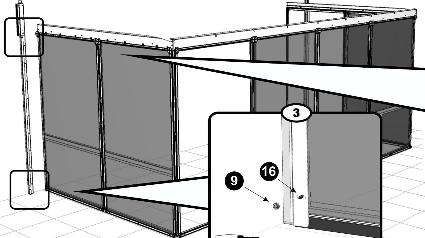
Percer un trou dans la section Ø5/16"
